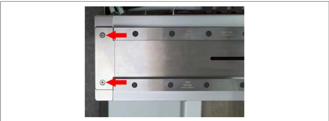
Abb. 64: Entfernen der seitlichen Abschlüsse
