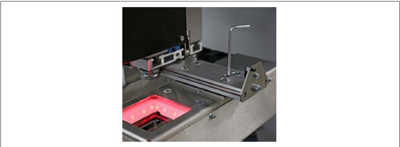
Abb. 14: Zum Korrigieren in Y-Richtung einen 3 mm Innensechskantschlüssel einsetzen. Zum Prüfen des Ergebnisses die Visionbox unter die Kamera schieben.
