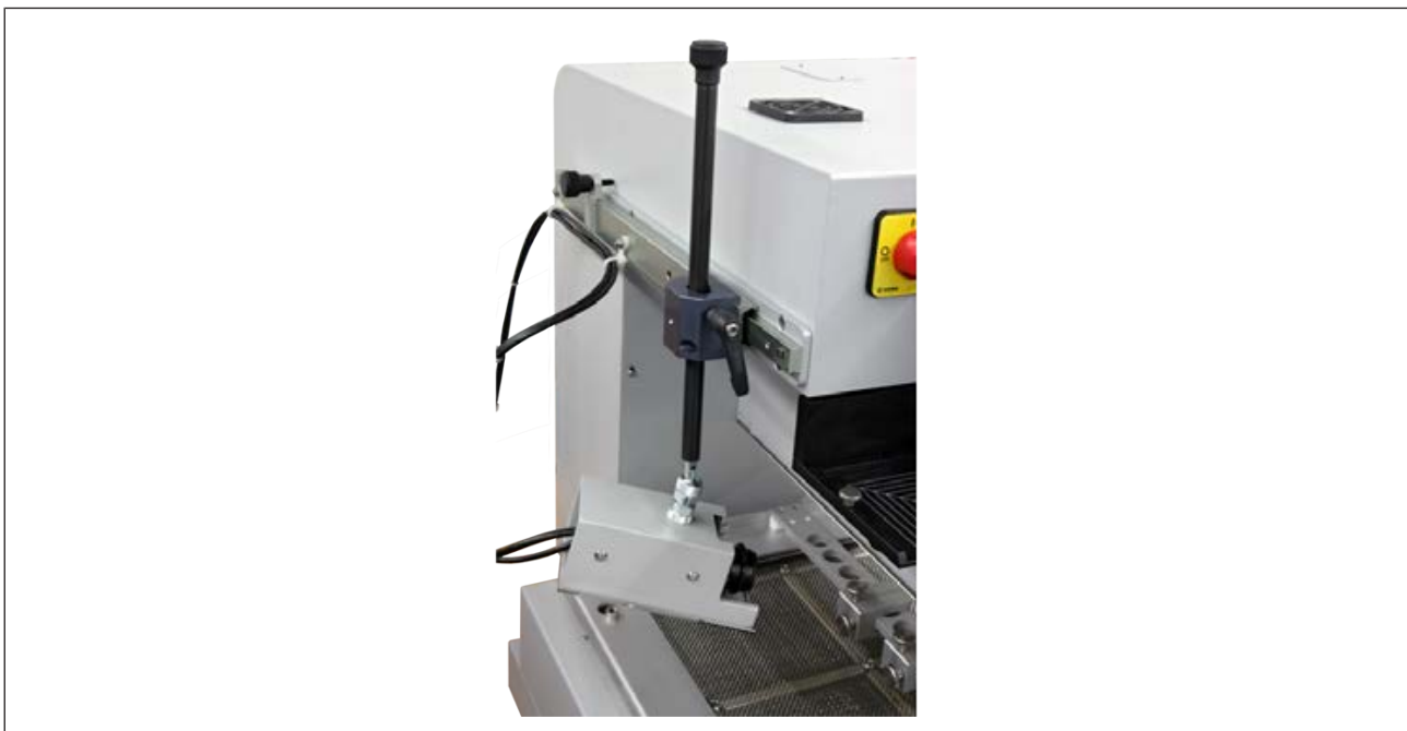
Abb. 6: RPC-Kamera montiert, Beispielabbildung
