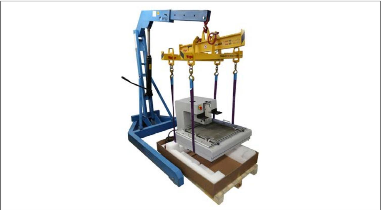
Abb. 4: Reworksystem mit einem Kran anheben
