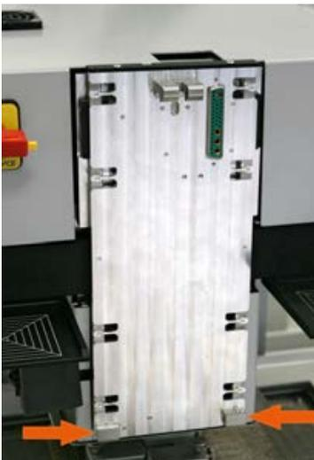
Abb. 48: Heizkopfaufhängung, Pfeile zeigen Auflagestützen
