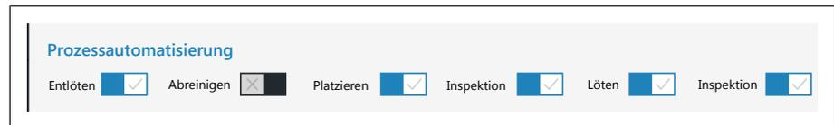
Mit diesen Schaltflächen werden die angezeigten Prozessschritte aktiviert oder abgeschaltet. Der Prozessablauf beginnt mit den ersten Prozessschritt links und führt die angewählten Prozessschritte nacheinander nach rechts durch.
