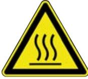
Alle beheizten Maschinenteile und die umliegenden Gehäuseteile, sowie der Leiterplattenhalter, die Leiterplatte und die Komponenten erhitzen sich schon während des Aufwärmens auf die Prozesstemperatur [Tinit]!
