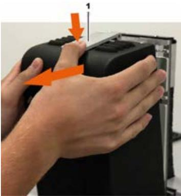
Abb. 47: Heizkopf entriegeln und abziehen.
