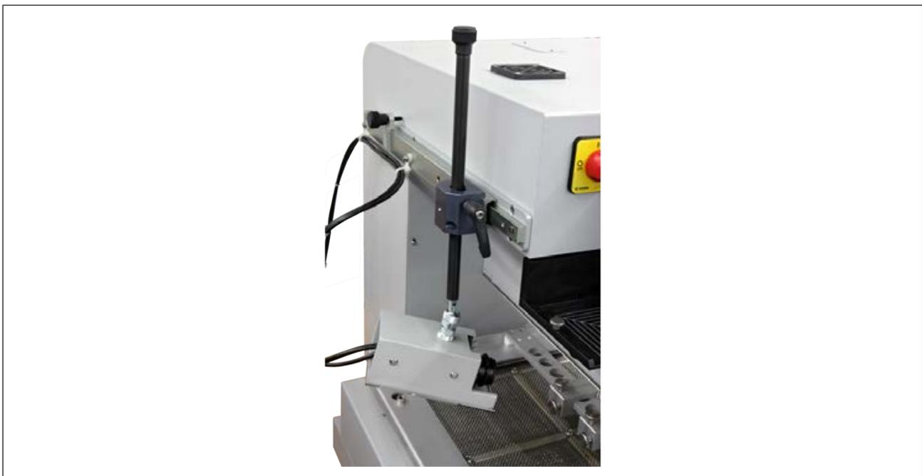
Abb. 12: RPC-Kamera montiert
