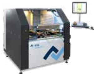
ECOSELECT 1: kleine Abmessungen – große Technik. Kompakte Batch-Anlage mit bis zu 2 Fluxköpfen und 2 Lötiegeln für Klein- und Sonder-serien
