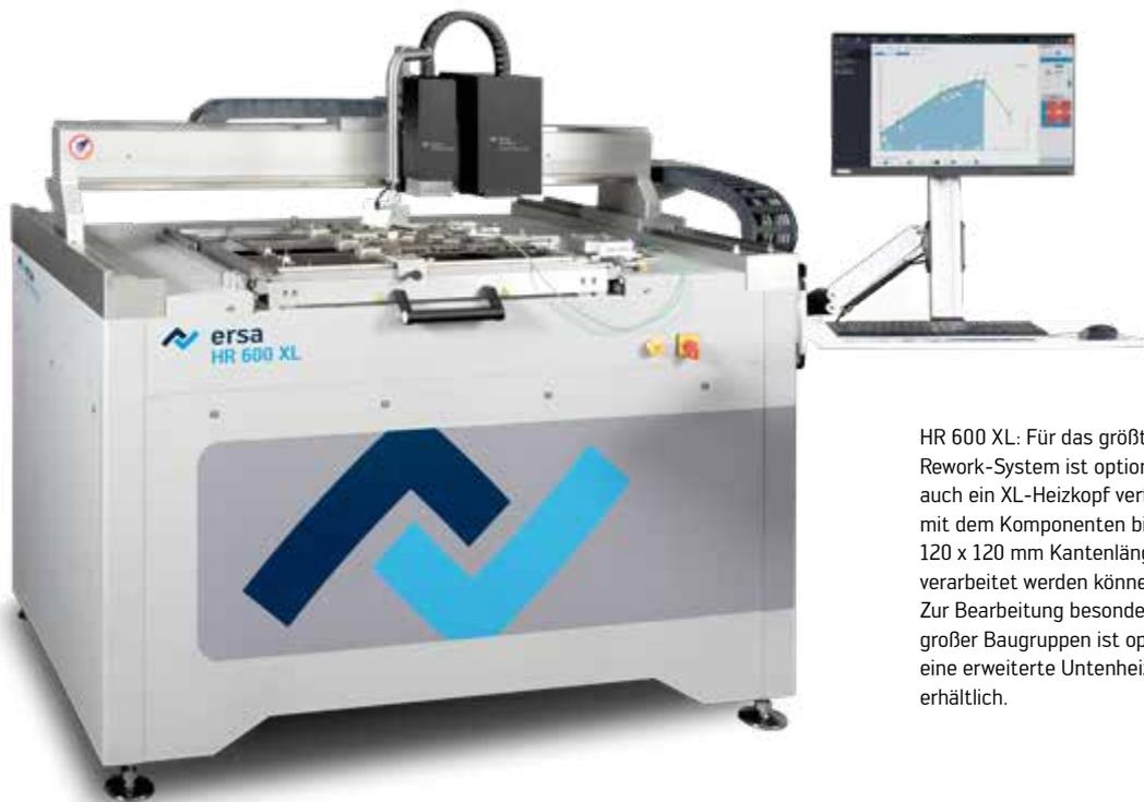
HR 600 XL: Für das größte Ersä Rework-System ist optional auch ein XL-Heizkopf verfügbar, mit dem Komponenten bis 120 x 120 mm Kantenlänge verarbeitet werden können. Zur Bearbeitung besonders großer Baugruppen ist optional eine erweiterte Untenheizung erhältlich.
