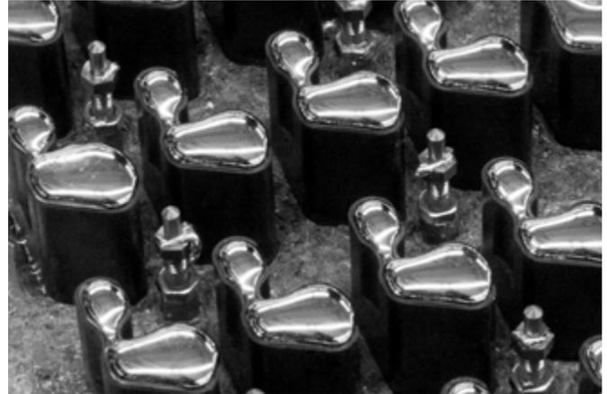
Neben Miniwellen-Lötmodulen in Einzeltiegeln bietet Ersä für große Stückzahlen Multiwellen-Lötmodule an, die in den VERSAFLOW Serien und der ECOCELL zum Einsatz kommen. Damit lässt sich die Zykluszeit extrem reduzieren und der Durchsatz - bei reproduzierbaren Lötgergebnissen- auf ein Höchstmaß steigern.
