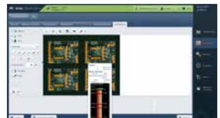
Einfach und schnell erstellt der Ersa CAD-Assistent 4 optimale Lötprogramme – mit Auto-routing und 3D-Ansichten.
