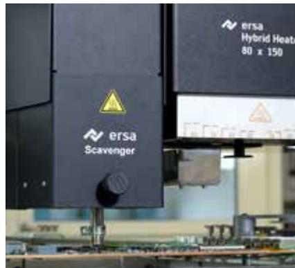
Links: "Auto Scavenger"-Modul am HR 600 XL zur berührungslosen Restlotentfernung auf einer Baugruppe. Rechts: Lotabsaugung bis zur vollständigen Entfernung, nachdem zuvor das Bauteil automatisch abgehoben wurde.
