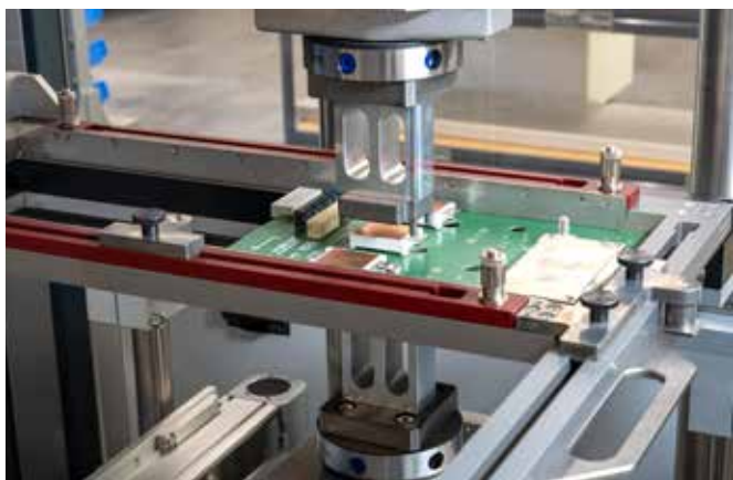
Die robuste Presseinheit sorgt für ein höchstes Maß an Präzision beim Einpressen.
