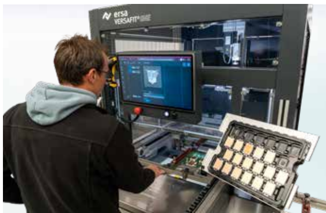
Warenträger wird mit wenig Kraft ins Transportsystem geschoben und das Programm gestartet.
