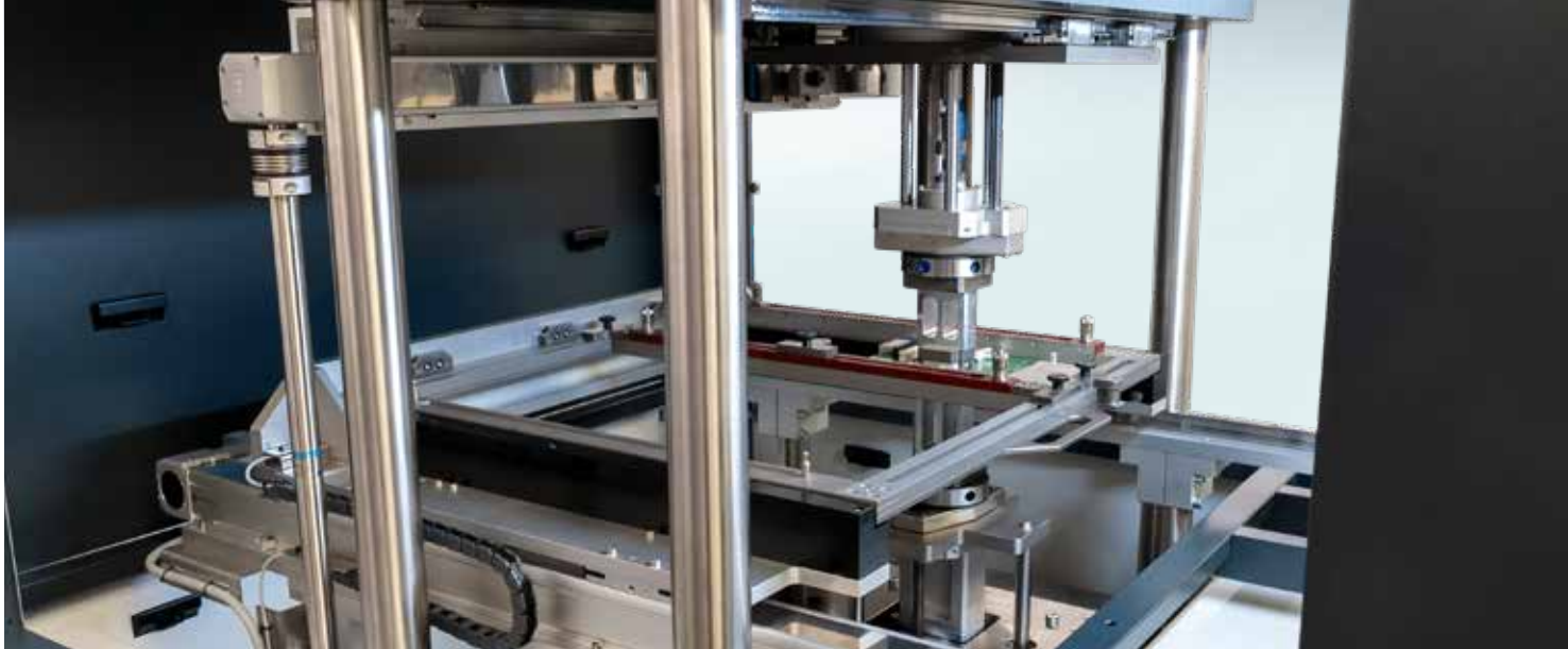
Die Maschinen positioniert selbständig und führt reproduzierbar die Einpressvorgänge durch.
