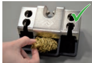
Verschmutzte Metallwolle entfernen, Lotauffangbehälter leeren
