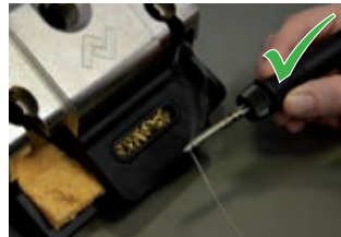
Nach Reinigung neues Lot zuführen
