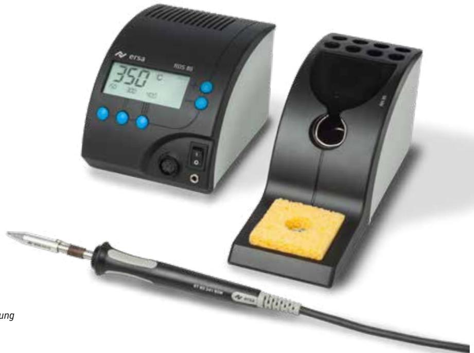
Die digitale Lötstation Ersä **RDS 80** mit der seit Jahren bewährten Ersä RESISTRONIC Temperaturregelung bietet **80 W** Heizleistung. Bei dieser Temperatur-Regelungstechnik übernimmt das keramische PTC-Heizelement (Positive Temperature Coefficient) die Funktion des Temperaturfühlers und garantiert durch die hohe Anfangsleistung ein äußerst schnelles Aufheizen.
