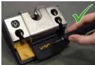
Lötspitzen leicht in die Metallwolle einstecken und drehen
