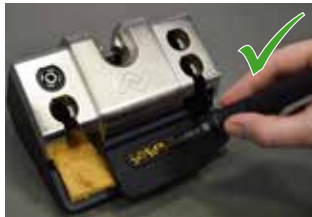
Lötspitzen- spitze leicht in die Metall- wolle einstecken und drehen
