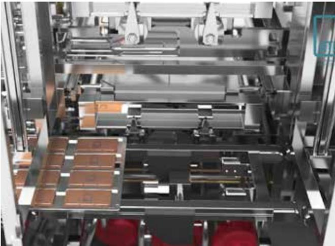
Transport des Produktträgers zur Prozesskammer
