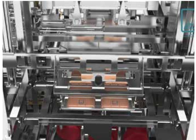
Aufnahme des Produktträgers durch das Liftsystem
