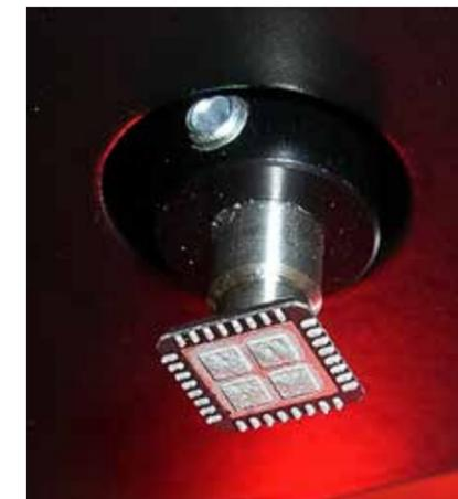
Mit Lotpaste bedrucktes BTC-Bauteil.
