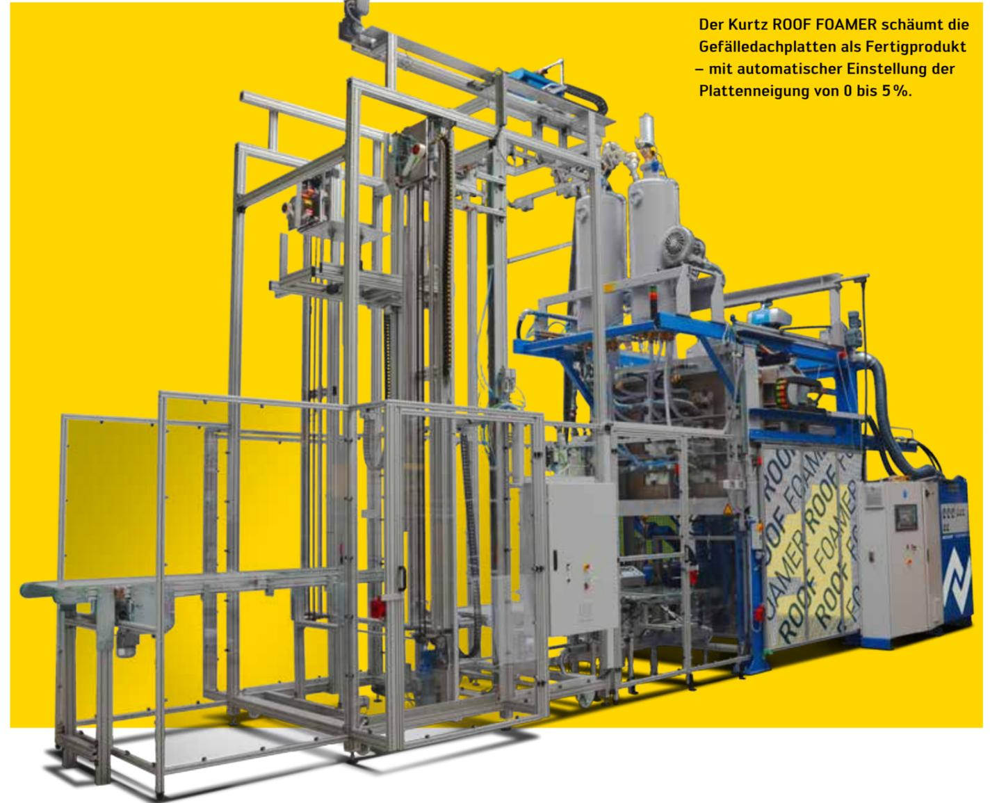
Der Kurtz ROOF FOAMER schäumt die Gefälledachplatten als Fertigprodukt – mit automatischer Einstellung der Plattenneigung von 0 bis 5 %.
