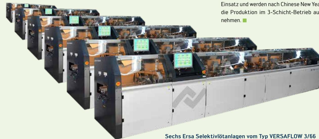
Sechs Ersä Selektivlötanlagen vom Typ VERSAFLOW 3/66 mit Doppelspur und sechs Lötmodulen (gr. Bild) gehen nach China an den Raumklima-Gerätehersteller Gree.
