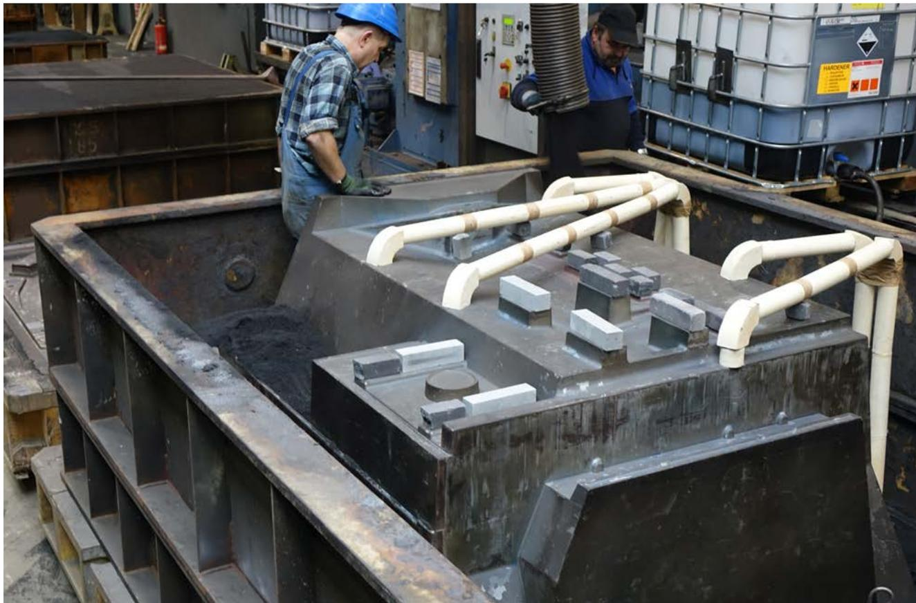
*Mitarbeiter im Einsatz bei der Formfüllung eines Maschinenbetts. Dabei kommt dem Verdichten des Sandes und dem Anbringen des Gießsystems eine hohe Bedeutung zu*
