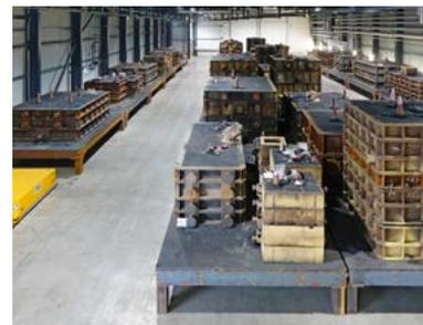
*Systemgesteuerte Auskühlhalle mit Be- und Entlüftungssystem und Wärmerückgewinnung*
