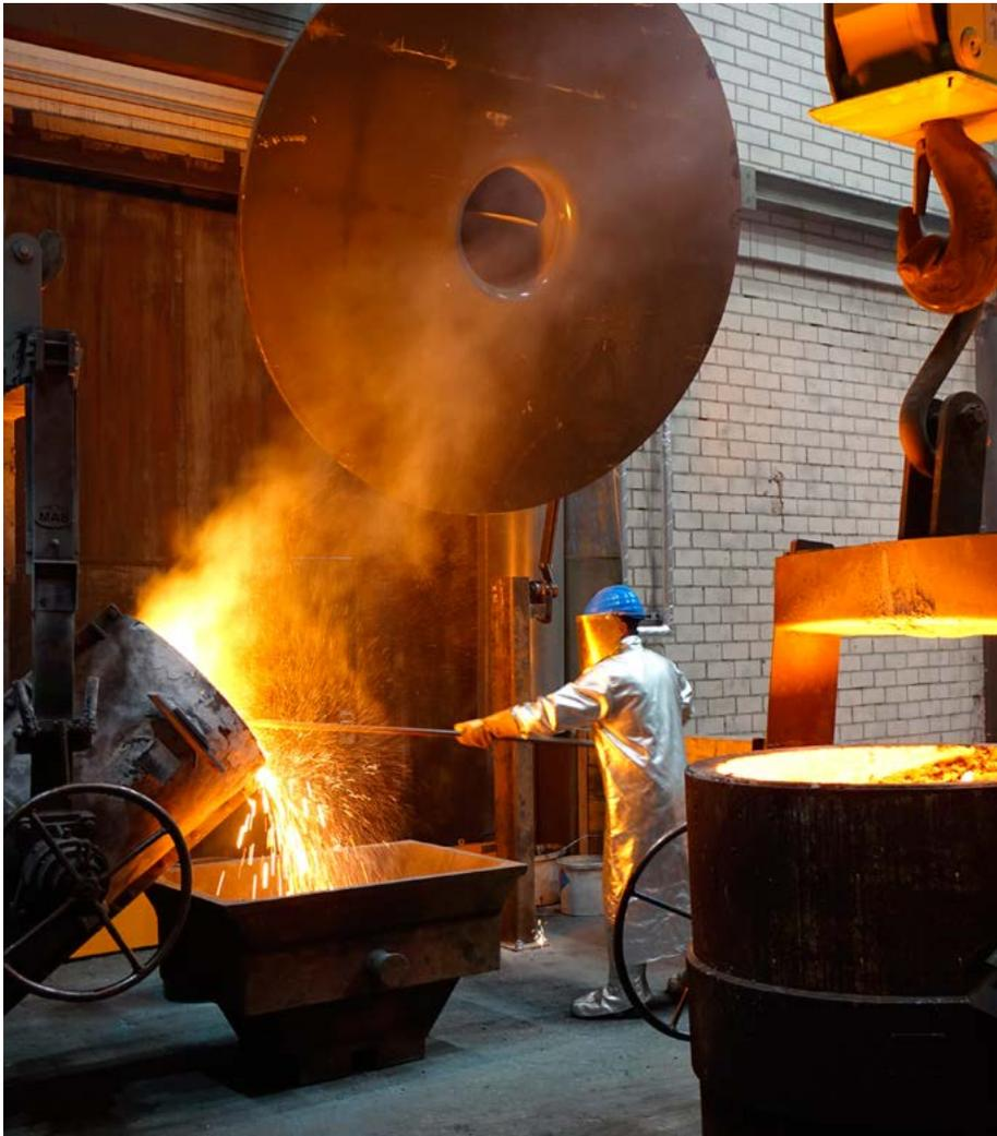
In der neuen Gießerei werden durch ein neues Be- und Entlüftungssystem optimale Arbeitsplatzbedingungen geschaffen. Der Gießprozess ist von den übrigen Produktionsprozessen in einer separaten Halle entkoppelt. Durch die Steuerung und Taktung der Produktion werden Schmelzen in höchster Qualität termingerecht her- und bereitgestellt.
