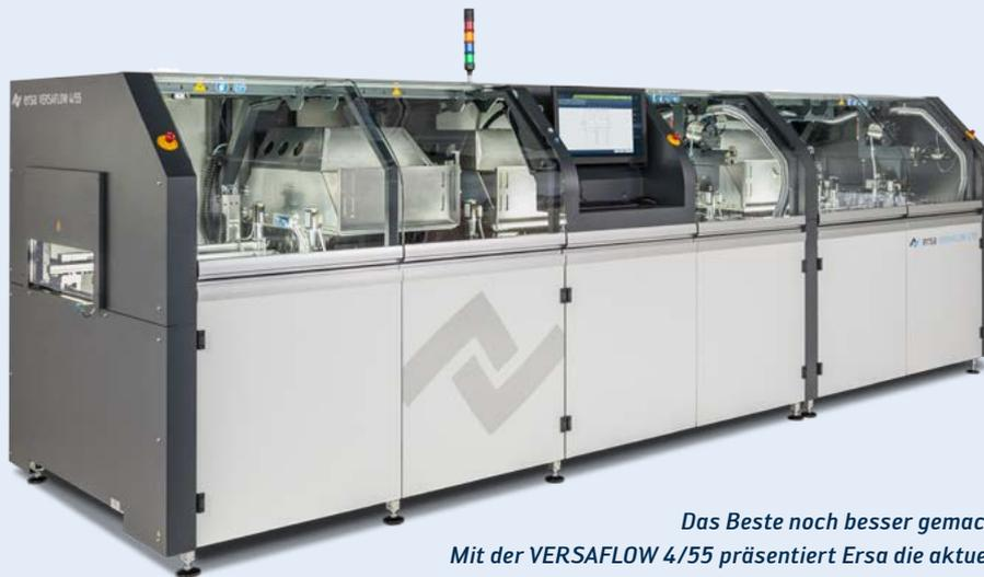
*Das Beste noch besser gemacht! Mit der VERSAFLOW 4/55 präsentiert Ersa die aktuelle Generation der weltweit führenden Online-Selektivlötplattform – unter anderem mit intuitiver Bedienoberfläche ERSASOFT 5.0, motorisch verstellbarer y-Achse bei Fluxer und Lötmodul, Y- und Z-Variabilität, max. 508 x 508 mm Bearbeitungsfläche im Durchlauf und abermals gesteigerter Prozessflexibilität.*
