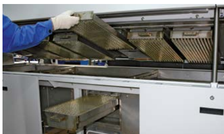
Schnelle und einfache Wartung durch optimale Zugänglichkeit und Anschlüsse mit Schnellkupplungen.
