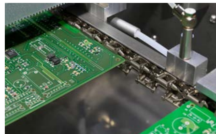
Die Flexibilität des Grip-Transportsystems erlaubt es, Leiterplattenstärken von 0,1 bis 6 mm im Mix ohne Abstand zu transportieren.
