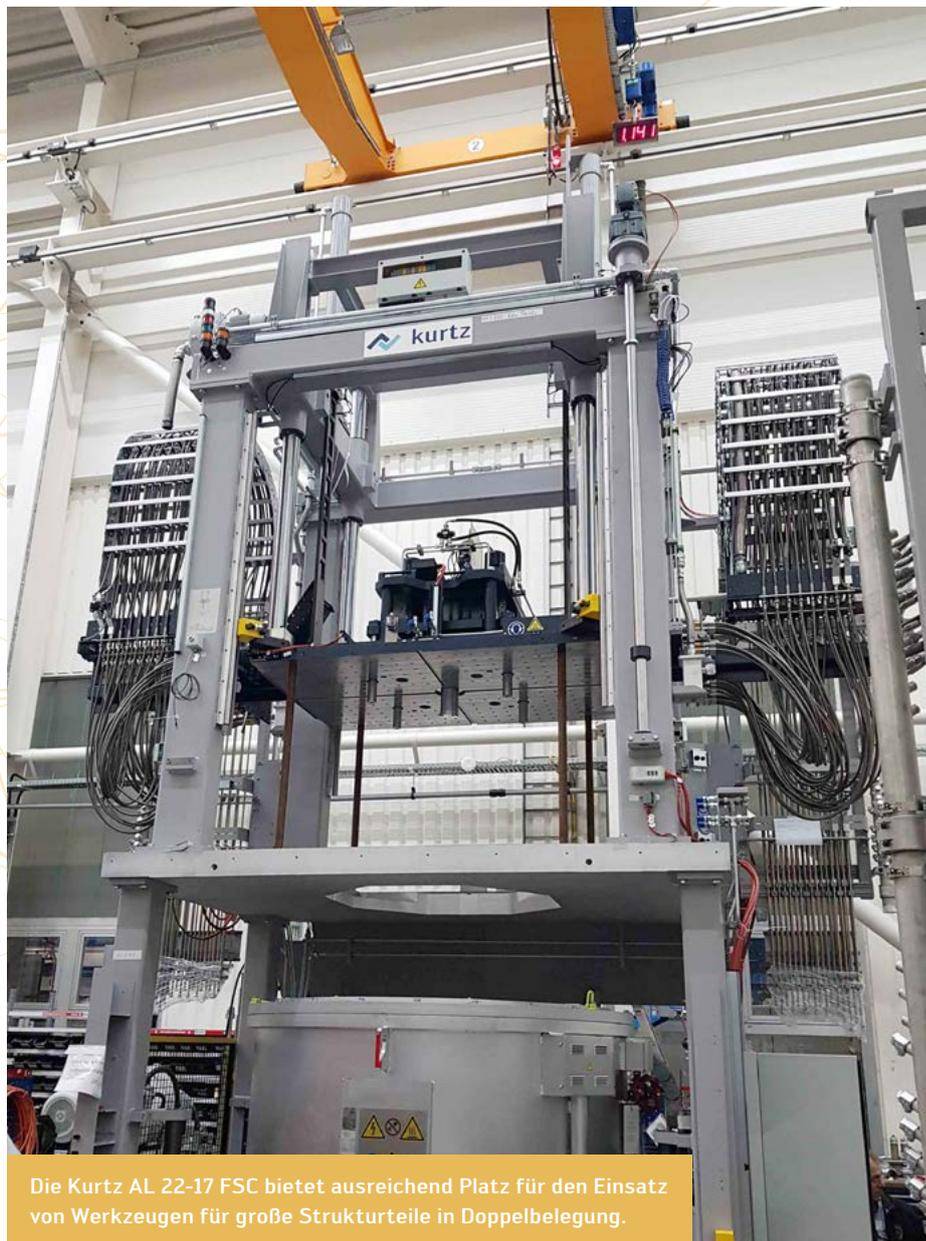
Die Kurtz AL 22-17 FSC bietet ausreichend Platz für den Einsatz von Werkzeugen für große Strukturteile in Doppelbelegung.
