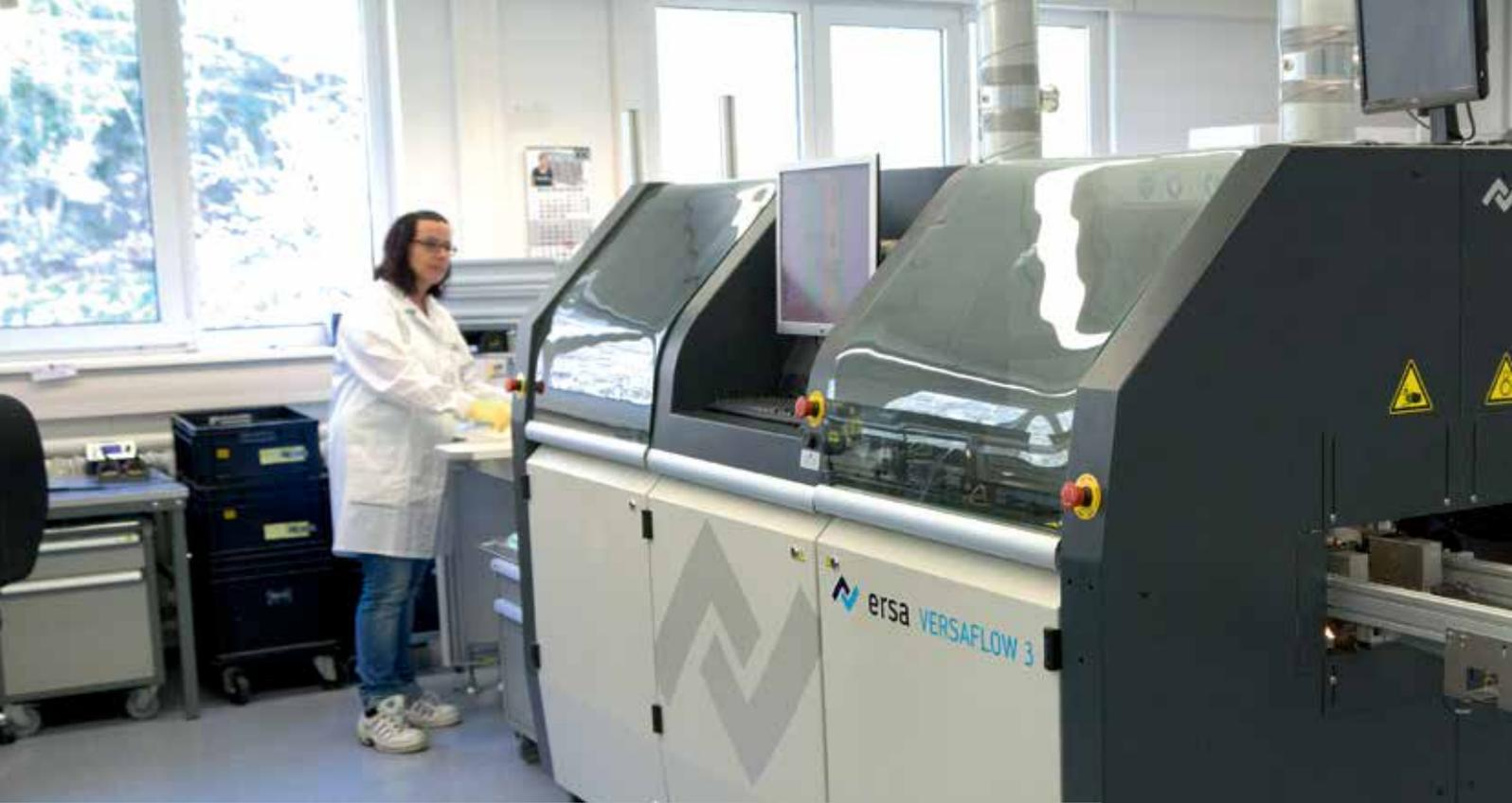
Mit zwei Tiegeln bestens gerüstet für höchstmöglichen Durchsatz: ErsafLOW 3/45 in der HUND Fertigung.
