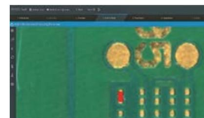
Dieser Screenshot zeigt Darstellung eines 01005-Bauteils nach der automatischen Ausrichtung.
