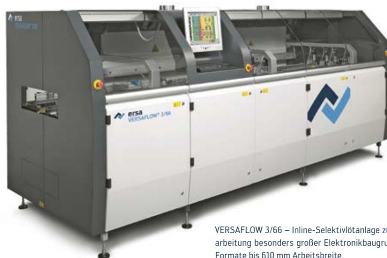
VERSAFLOW 3/66 – Inline-Selektivlötanlage zur Verarbeitung besonders großer Elektronikbaugruppen-Formate bis 610 mm Arbeitsbreite.
