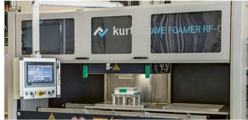
Weg vom Wasserdampf: Die neue Technologie nutzt Radiofrequenz für die Versinterung von Schaumbeads zu Formteilen – mit Schmelzpunkten bis über 240 °C rücken komplett neue Anwendungsmöglichkeiten in den Blick, etwa als Dämmstoffe, Verpackungen und im Leichtbau für die Mobilität.
