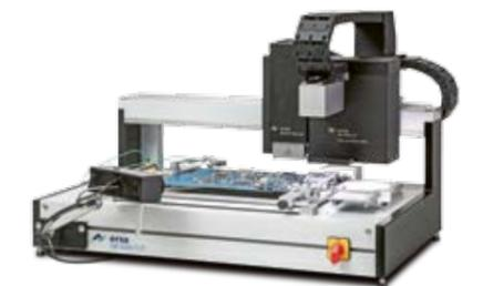
Das gesamte Spektrum der Bauteil- und Platinengrößen: Mit HR 500, HR 550 XL und HR 600/3P setzt Ersa Maßstäbe in der Baugruppenreparatur.
