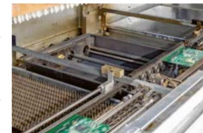
Optimale Temperaturprofile durch mittelwellige Heizstrahler im Vakuummodul. Dessen schmiermittelfreier Rollentransport ist extrem wartungsfreundlich und lässt sich mit wenigen Handriffs ohne Werkzeug entnehmen.
