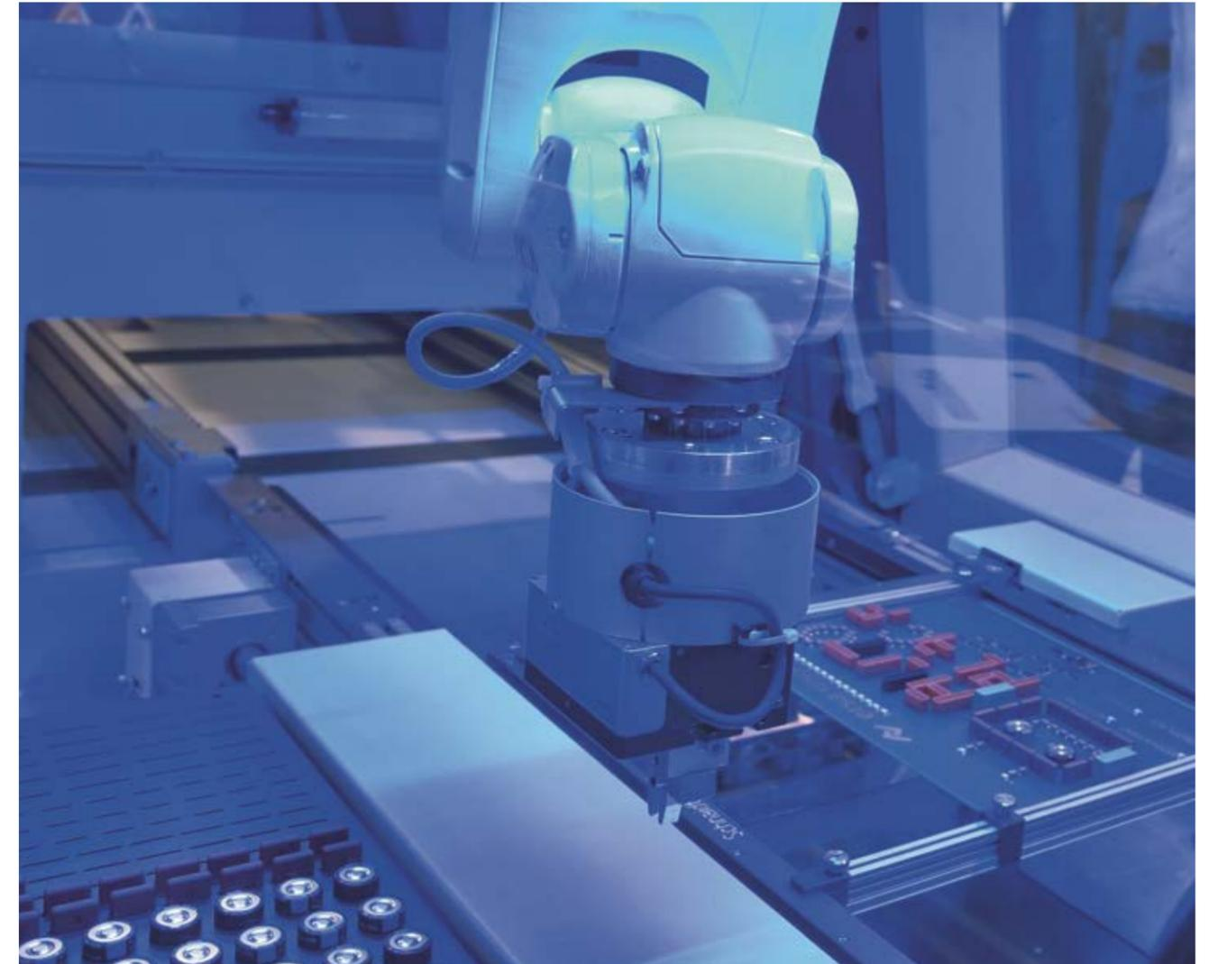
Konzipiert für wiederkehrende Bestück- und Montagearbeiten: der Ersa ROBOPLACE.
