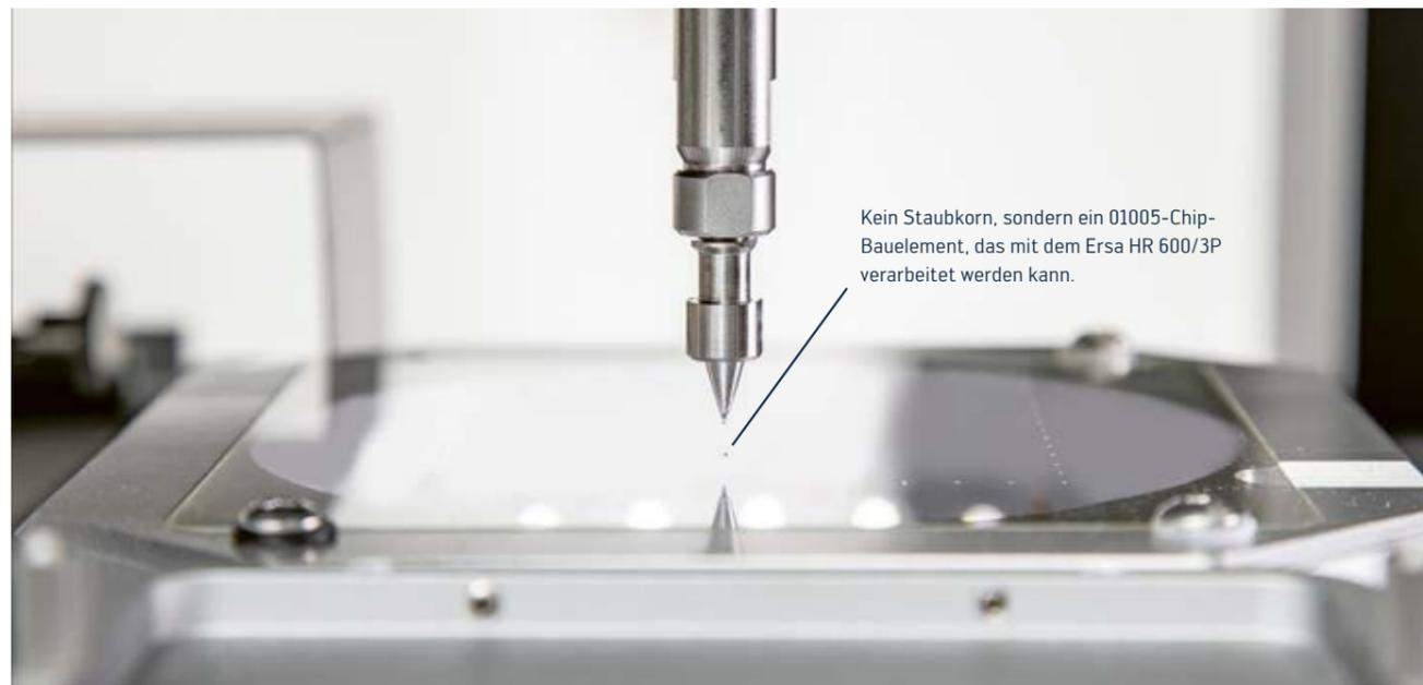
Kein Staubkorn, sondern ein 01005-Chip-Bauelement, das mit dem Ersa HR 600/3P verarbeitet werden kann.
