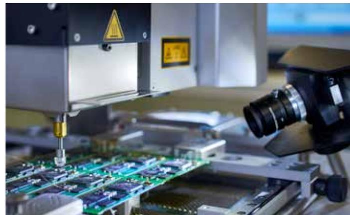
Vor allem für den Prototypenbau wird auch ein ErsA HR 600 Reworksystem eingesetzt, um die Wertschöpfung der immer komplexer werdenden Elektronikbaugruppen zu erhalten
