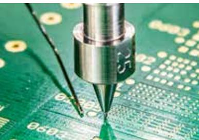
Platzierung eines 01005-Chips mit dem Ersä Hybrid Rework System HR 600/3P
