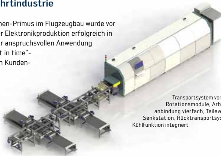
Transportsystem vorgeschaltet, Rotationsmodule, Arbeitsplatzanbindung vierfach, Teileverfolgung, Senkstation, Rücktransportsystem mit Kühlfunktion integriert
