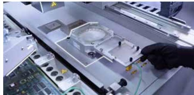
Dip&Print Station an der HR 600 XL zum definierten Flussmittelauftrag bei BGA
