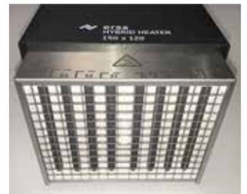
Der XL-Heizkopf des Ersa HR 600 XL für Bauteile bis 150 x 120 mm Kantenlänge
