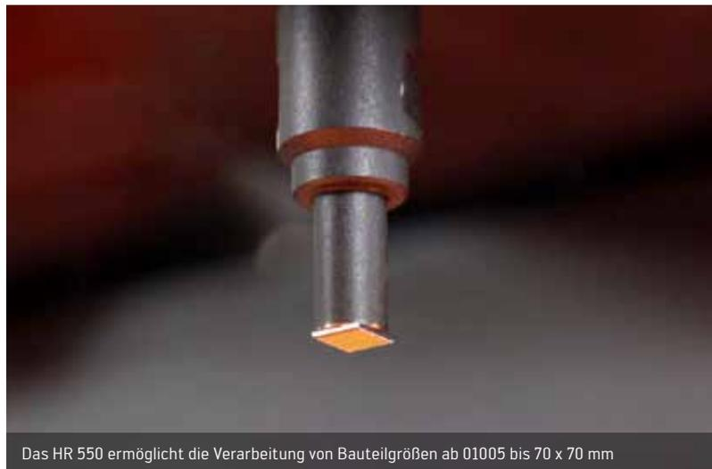
Das HR 550 ermöglicht die Verarbeitung von Bauteilgrößen ab 01005 bis 70 x 70 mm
