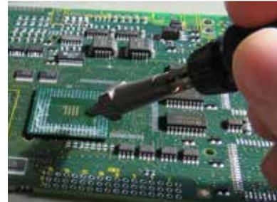
Abziehen des Restlots mit einem LötKolben
