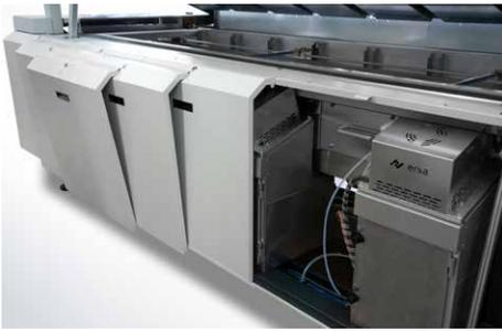
Leichte Zugänglichkeit der Komponenten (z.B. der SMART ELEMENTS® Granulatfilter als erster Schritt des dreistufigen Reinigungssystems) macht die Maschinenwartung unkompliziert und schnell
