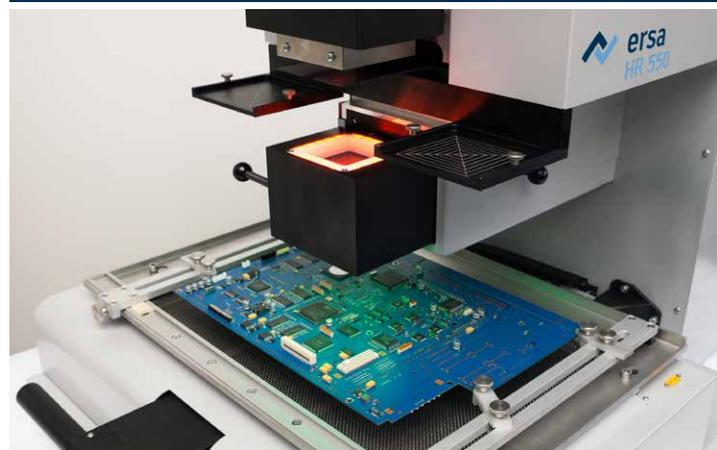
Ersa HR 550 – leistungsstarkes, halbautomatisches Table-Top-Rework-System
