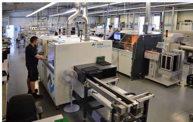
Der neue THT-Bereich bei VOIGT electronic mit VERSAFLOW ONE und ECOSELECT
