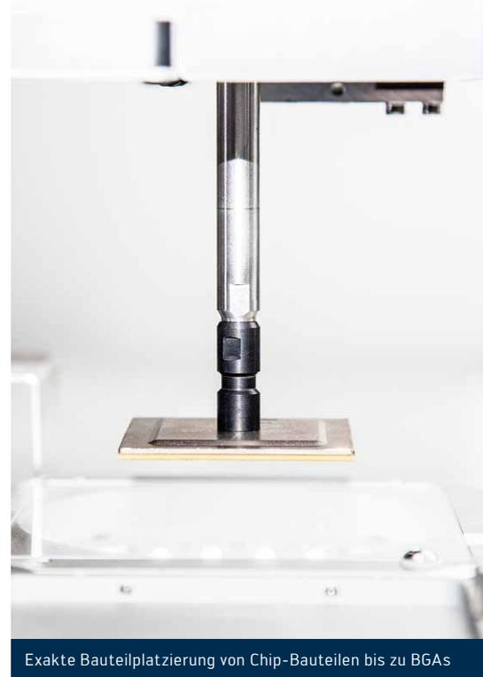
Exakte Bauteilplatzierung von Chip-Bauteilen bis zu BGAs
