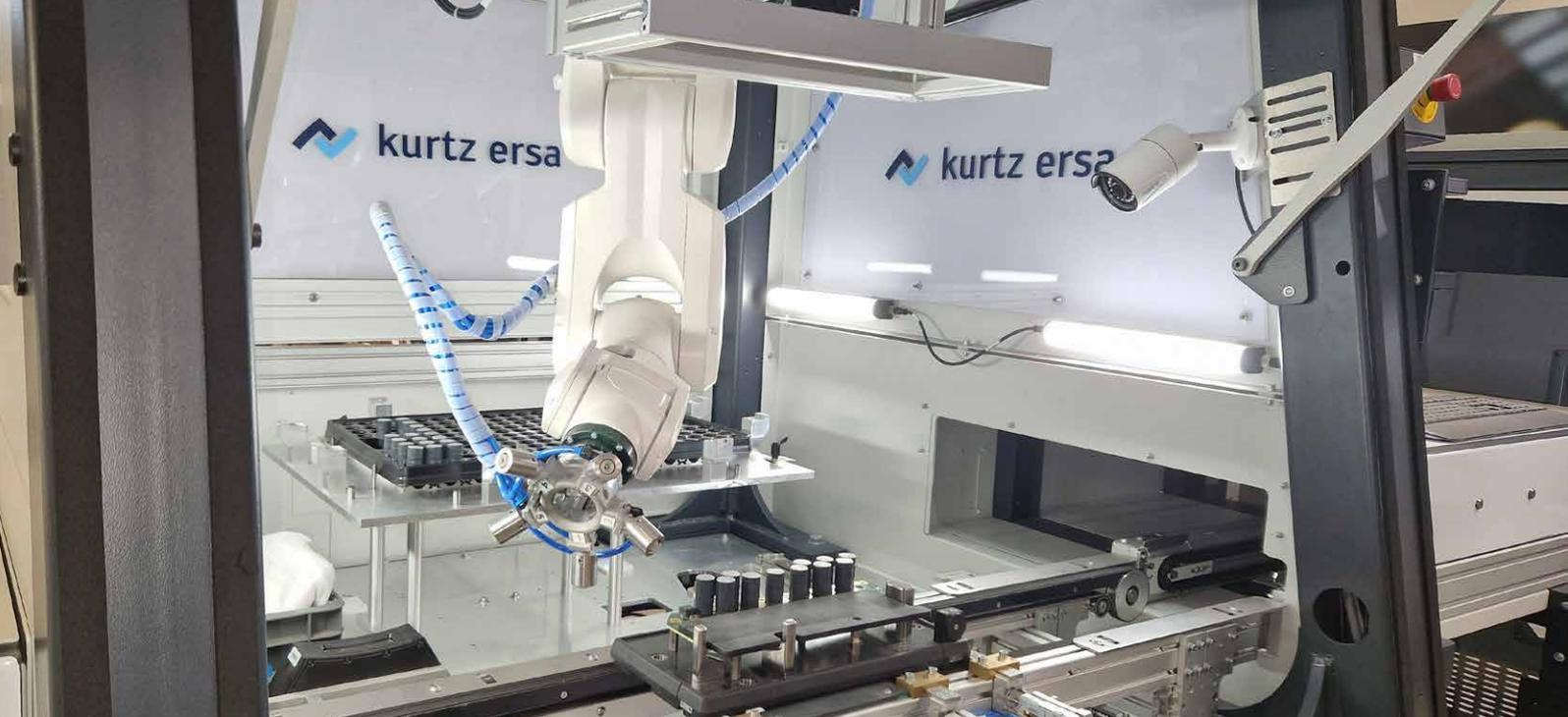
Blick in die Roboterzelle des Kurtz Ersä ROBOPLACE während eines Bestückvorgangs
