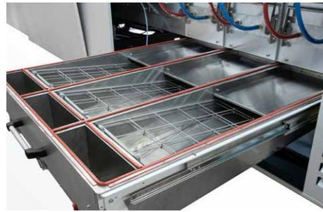
Maschinenverfügbarkeiten (OEE) mit bis zu zwölf Wochen Dauerbetrieb ohne Wartungsintervall durch das dreistufige Ersa Smart Cleaning System; im Bild die SMART CONDENSATION UNIT
