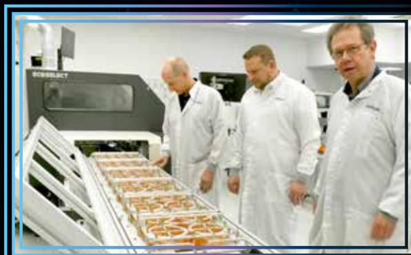
2,4 m langer Warenträger, der aus einem Stück gefräst und mit einer Baugruppe bestückt ist
