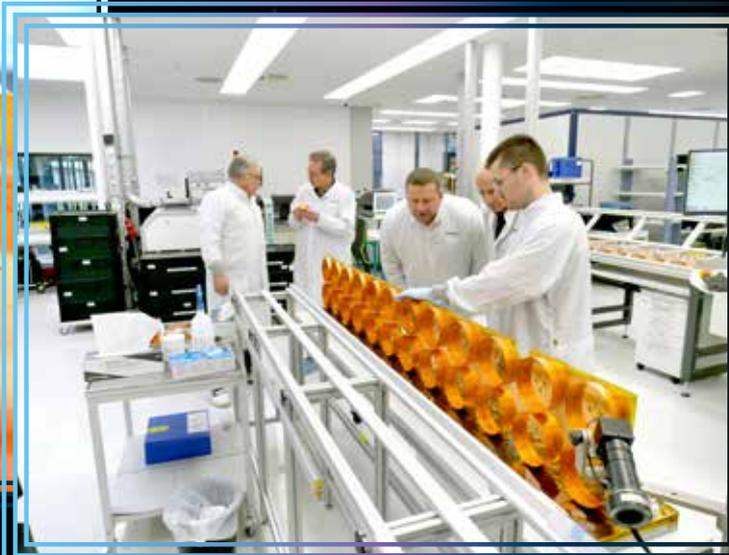
Fertig montiertes Subarray mit 24 Ringstrukturen
