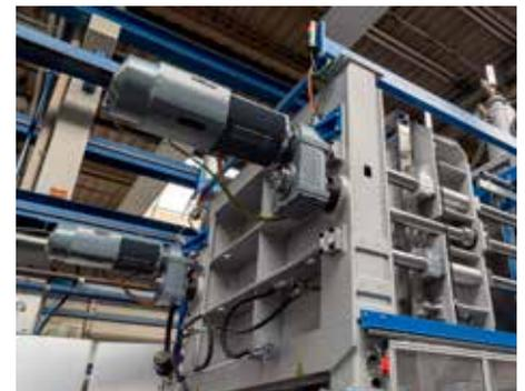
Schnelle Antriebsarten für die CoreLess-Technologie, hier: Kurtz POLY FOAMER mit elektrischen Antrieben
