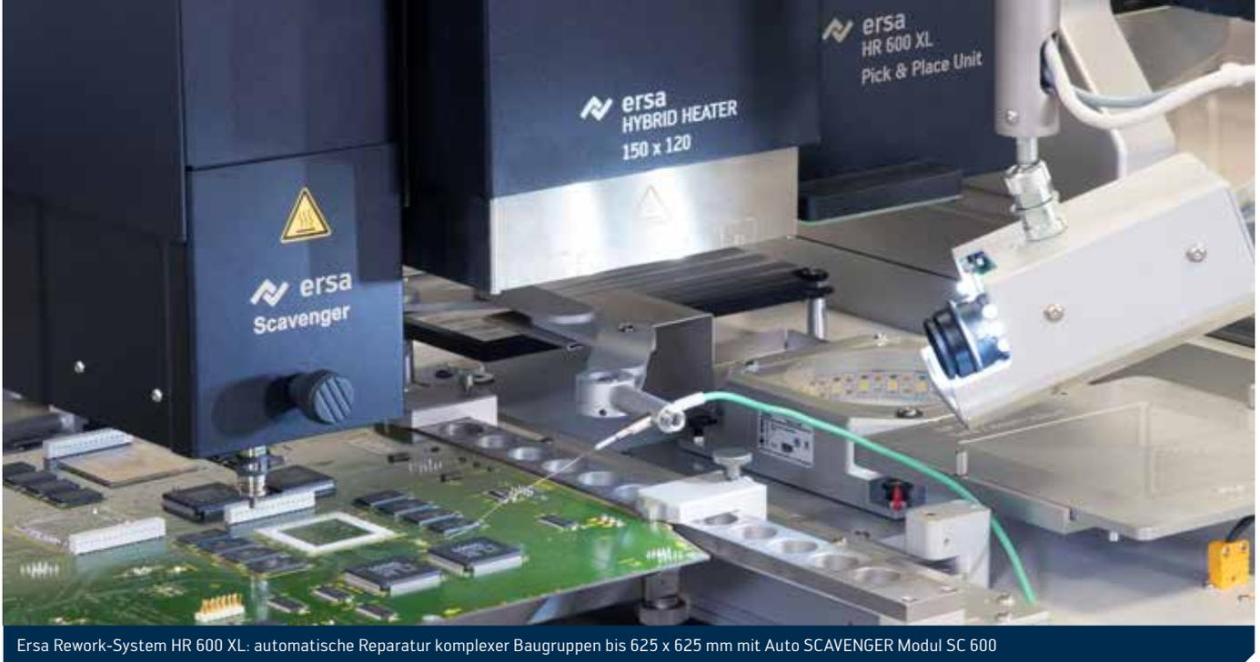
Ersa Rework-System HR 600 XL: automatische Reparatur komplexer Baugruppen bis 625 x 625 mm mit Auto SCAVENGER Modul SC 600
