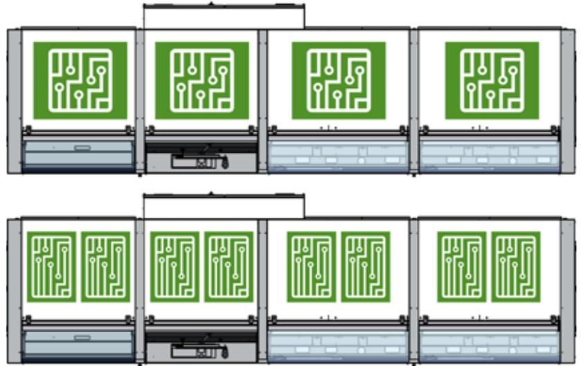
Oben: 4 Leiterplatten mit max. 610 x 508 mm in der VERSAFLOW ONE XX (3 LP bei Version ONE X); unten: 8 LP mit max. 350 x 508 mm in der ONE XX mit zweitem Stopper (6 LP mit ONE X)
