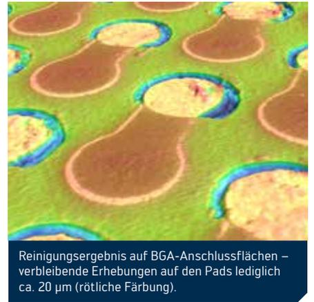
Reinigungsergebnis auf BGA-Anschlussflächen – verbleibende Erhebungen auf den Pads lediglich ca. 20 µm (rötliche Färbung).
