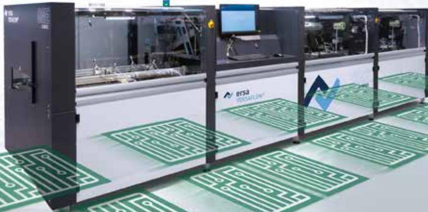
Die VERSAFLOW ONE XX ermöglicht mit zwei x-variablen Lötmodulen und bis zu 4 Lötziegeln Highspeed-Durchsatz in hoher Lötqualität zu geringen Investitionskosten
