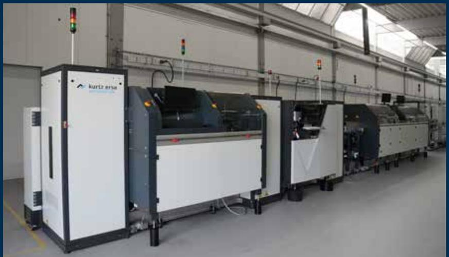
Gesamtanlage bestehend aus Bürst-Station, Röntgenstation und Lötanlage
