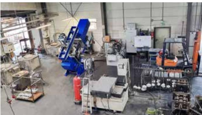
Die neue Heimat der Kurtz AK01 bei der Metallgießerei Brückner in Zeulenroda-Triebes: Produktionsbereich für zukünftige Gussteile im Kippguss-Verfahren
