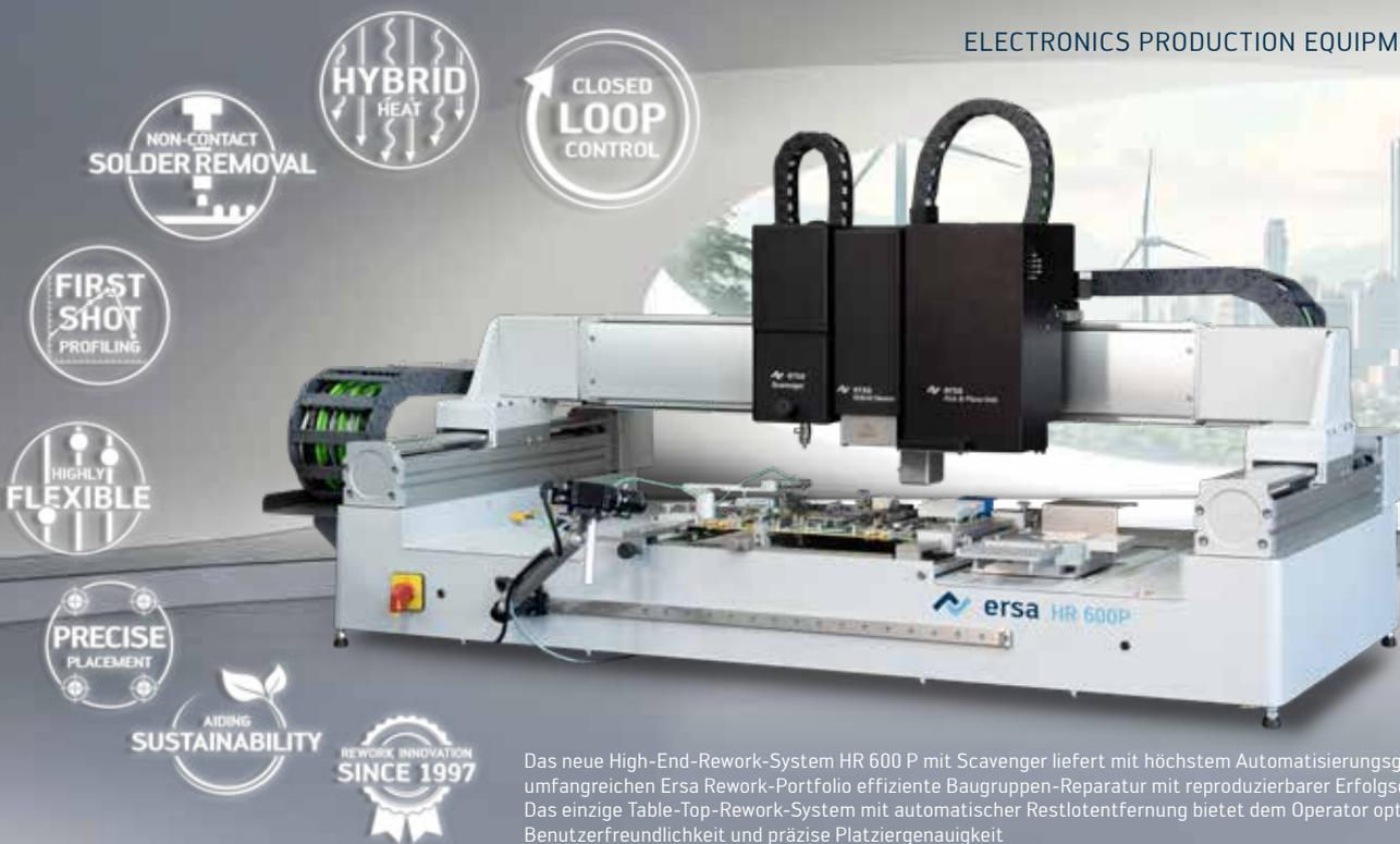
Das neue High-End-Rework-System HR 600 P mit Scavenger liefert mit höchstem Automatisierungsgrad im umfangreichen Ersa Rework-Portfolio effiziente Baugruppen-Reparatur mit reproduzierbarer Erfolgsquote. Das einzige Table-Top-Rework-System mit automatischer Restlotentfernung bietet dem Operator optimale Benutzerfreundlichkeit und präzise Platziergenauigkeit.
