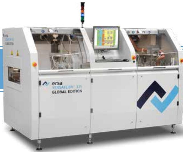
Die InLine-Selektivanlage VERSAFLOW 3/35 bietet höchste Flexibilität und höchsten Durchsatz bei kleinstem Platzbedarf (L x B x H: 2.450/1.750/1.650 mm) zum attraktiven Preis
