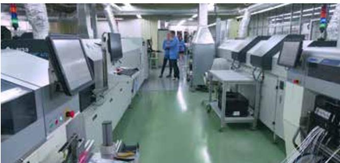
Blick in die INOTECH-Elektronikfertigung mit Ersa Reflowlötanlagen vom Typ HOTFLOW 4/14, die dreimal am Standort Kaplice installiert ist
