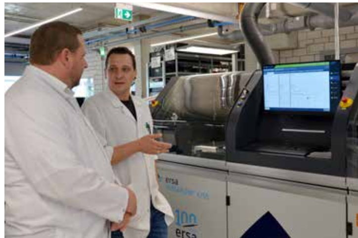
Geht da noch was mit der VERSAFLOW 4/55? Regelmäßig bewegt man sich an der Grenze des physikalisch Machbaren und meistert selbst feinste Pin-Abstände von 0,4 mm
