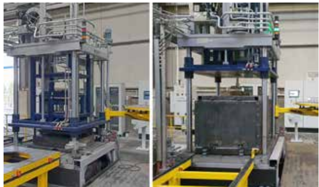
Höchste Flexibilität für Kundengießereien: Kurtz AL13-13SC „2-in-1-Lösung“ – links: Kokille, rechts: Sandform/Kernpaket
