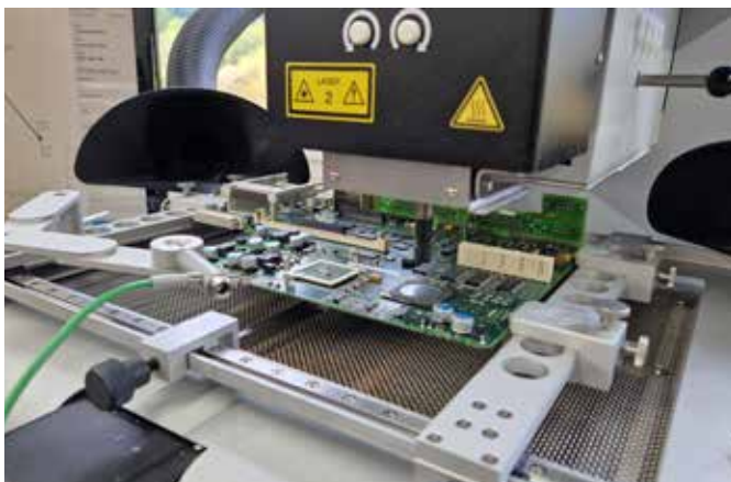
Der Heizkopf ist über dem zu entlötenden BGA platziert und dieses kann mittels Closed Loop-Regelung sicher ausgelötet werden
