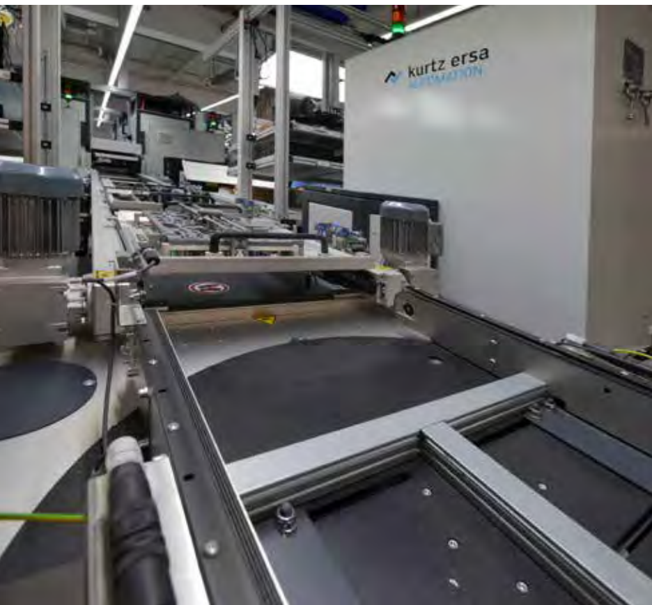
Drehstation innerhalb der neuen Bestücklinie bei Ziehl-Abegg
