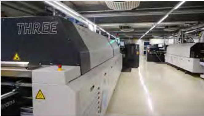
HOTFLOW THREE Reflowlötanlage in der TELE Elektronikfertigung
