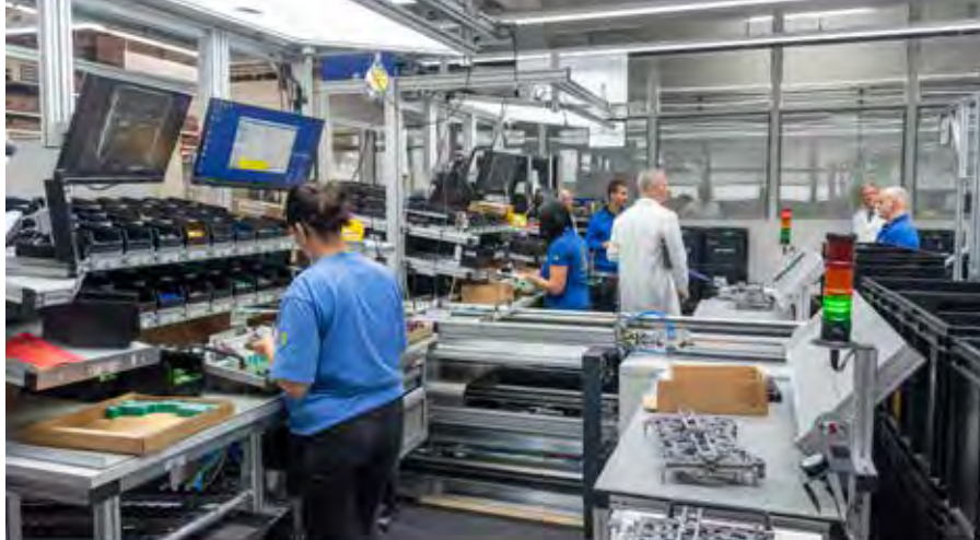
Automatisierte 29-m-Linie bei Ziehl-Abegg mit acht Bestücktischen und automatisierter Bestückkontrolle
