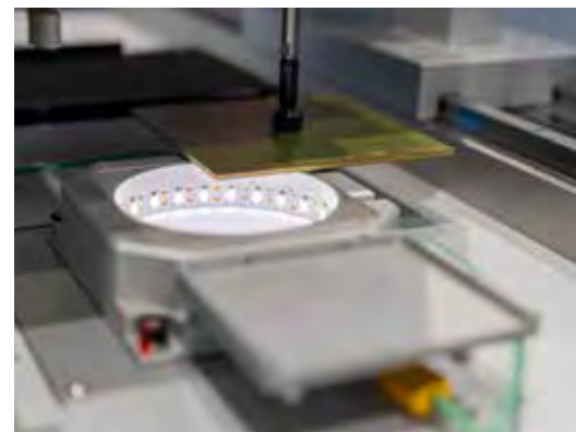
Die Bauteilkamera nimmt die Eck-Anschlüsse des BGA auf, um es anschließend zu platzieren
