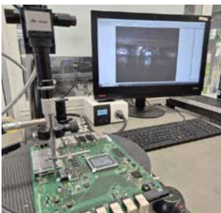
Baugruppeninspektion bei Lawo mit dem Ersascope ERSASCOPE
