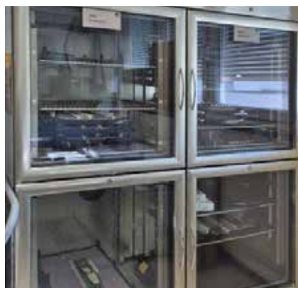
Bauteiltrocknung im SuperDry-Trockenlagerschrank
